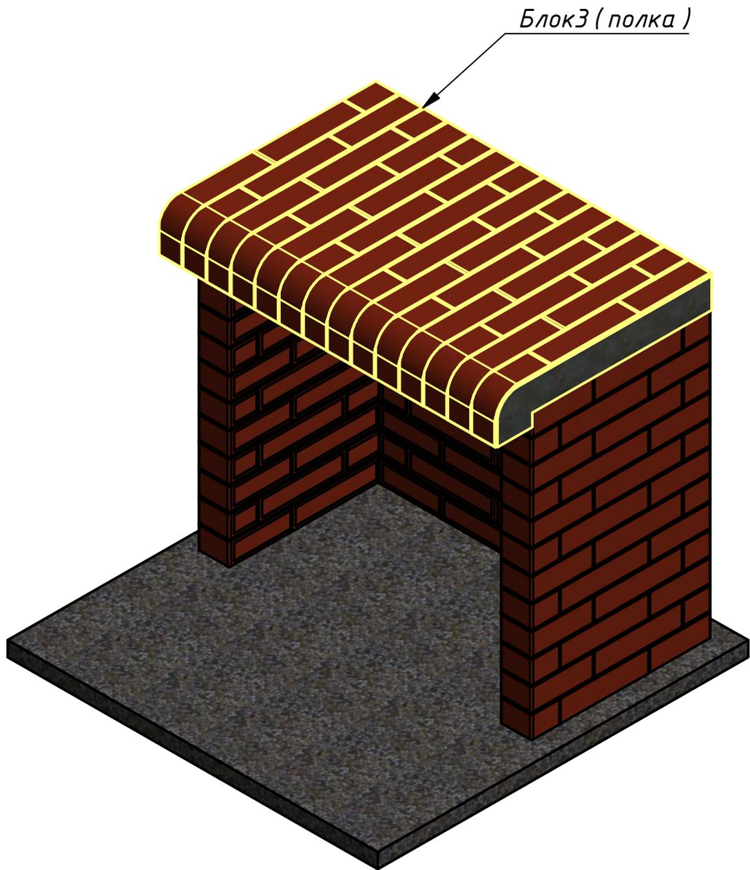
Блок3 закрепляем снизу гайками М6 к ушкам верхней пластины.
