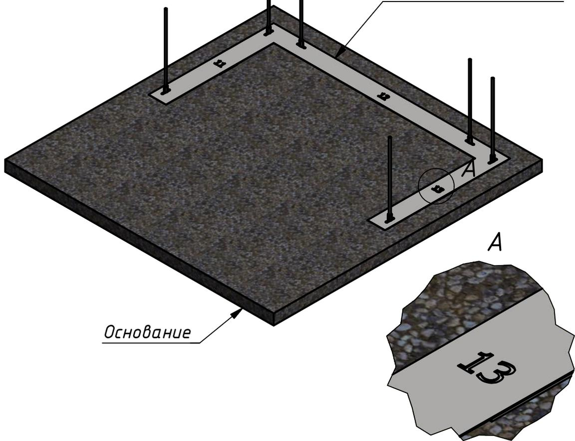
Сборку модуля начинаем на подготовленном основании. Блоки надеваем на шпильки, склеивая между собой герметиком и скрепляя гайками через пластины. Блоки дополнительно пронумерованы по месту расположения – слева направо по часовой стрелке. Первая цифра – номер ряда, вторая – номер блока в ряду. Например 13 – третий блок первого ряда.
